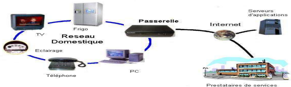
Figure 4 : Plate forme domotique
